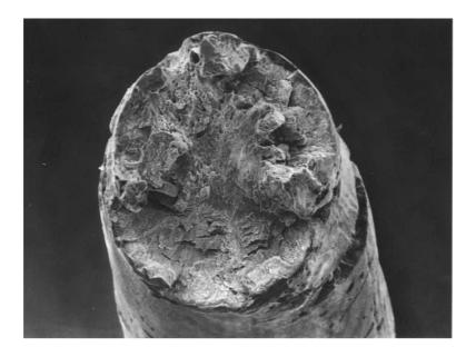
Fig. 9.14. Superficie de fractura frágil debida a CBT. Alambre de latón traccionado en una solución acuosa de NaNO<sub>2</sub>. Nótese la diferencia con la Fig. 9.6. Hay una pequeña reducción en el diámetro del alambre, y se observan fisuras en los costados del mismo (1).
