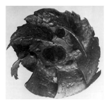
Fig. 11.1. Erosión-corrosión producida sobre una hélice de bomba impulsora (2)
