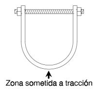
Fig. 9.16. Probeta para ensayos por la técnica de deformación impuesta ("U" bend)
