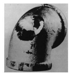
Fig. 11.4. Rotura de curva de una línea de vapor condensado debido al "impingement".
