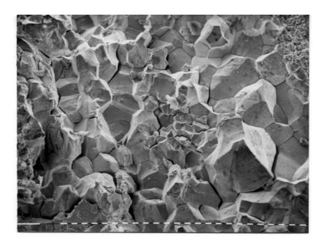
Fig. 9.19. Superficie de fractura de corrosión bajo tensión intergranular. Ag-15Pd traccionado en tolueno saturado con yodo. (400X) (Duffó (29)).
