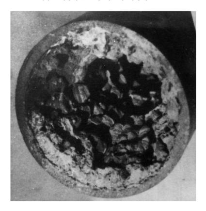
Fig. 14.2. Tuberculaciones de hidróxido férrico originadas por microoganismos y adheridas sobre el interior de una cañería de acero al carbono
