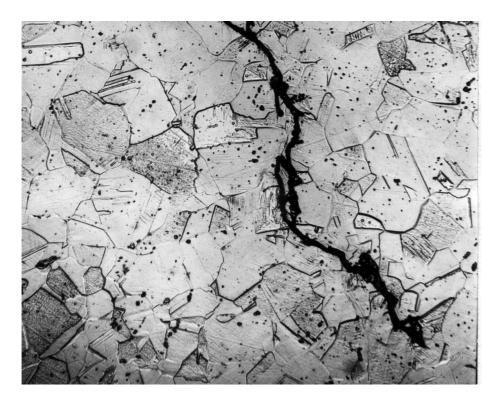
Fig. 9.20. Corrosión bajo tensión transgranular de acero inoxidable austenítico en cloruros. Corte metalográfico. (300X).
