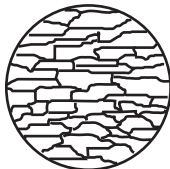
Estructura la salida del laminador
