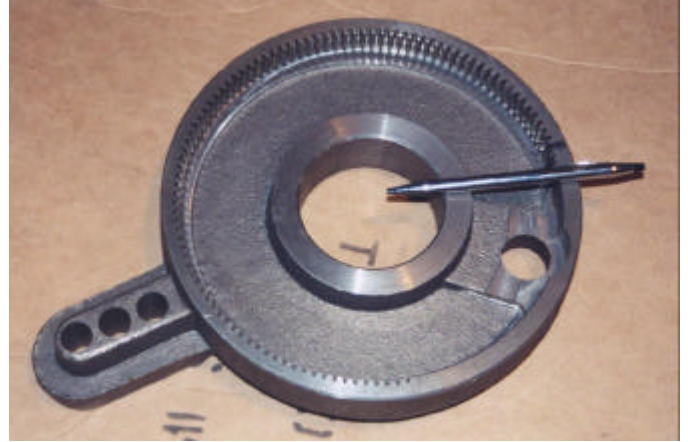
Figure 28 : ADI Conduit Bender Gear
