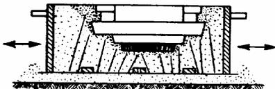
Se levanta la caja, se da vuelta y se apoya sobre el lecho de arena, adaptándola a él con movimientos en el sentido de la flechas
