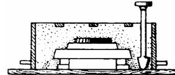
Se ataca la arena contra las paredes de la caja y en torno al modelo
