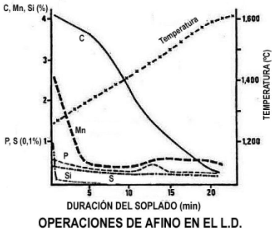
Fig. 13. Acería convertidor al oxígeno LD y proceso de afino en el mismo.
