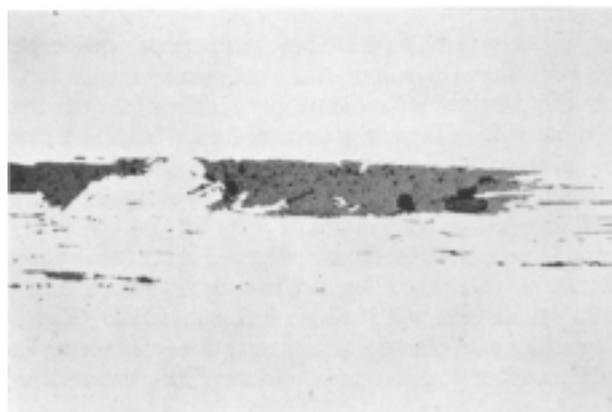
**Fig. 32.** Inclusión exógena, probablemente refractario, en acero laminado en caliente (5x).
