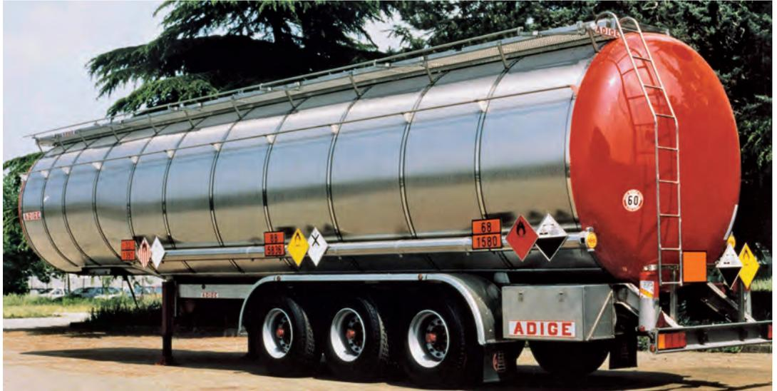
**Camión cisterna para el transporte de asfalto de acero inoxidable de baja aleación dúplex (Fuente: Outokumpu)**
