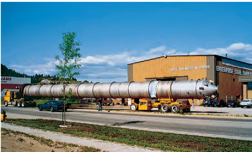
Reactor de designificación con oxígeno fabricado con EN 1.4462 (2205), Enterprise Steel Fab, Kalowna, Prince George, Columbia Británica, Canadá (Fuente: Outokumpu)
